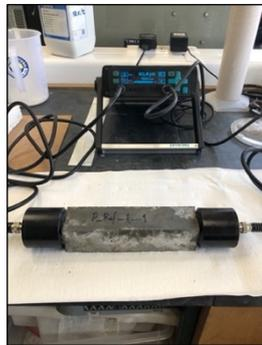
Figura 3.45 – Ensaio de ultrassons a um provete de pasta de referência.
