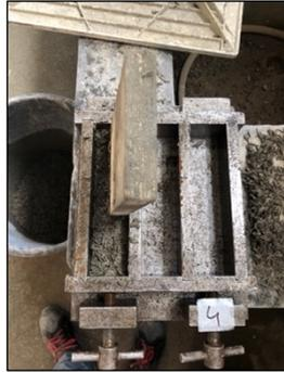
Figura 3.9 – Processo de enchimento do molde.
