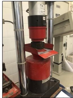
Figura 3.41 – Provede do compósito de referência a ensaiar à compressão.
