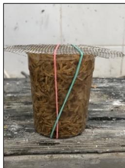
Figura 3.24 – Copo cheio com CA seca e água, para o índice de vazios.
