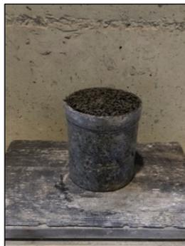
Figura 3.32 – Ensaio de massa volúmica no compósito.
