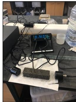
Figura 3.46 – Ensaio de ultrassons a um provete de compósito de referência.
