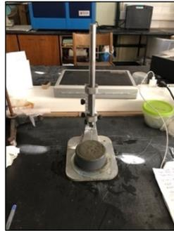
Figura 3.38 – Determinação do início de tempo de presa.
