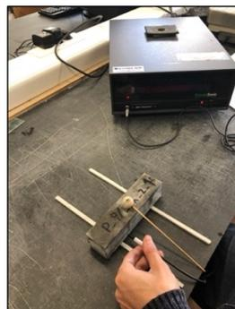
Figura 3.43 – Execução do modo de vibração flexional.
