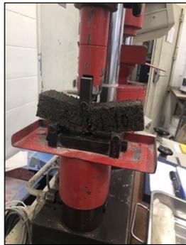
Figura 3.40 – Provede do compósito de referência ensaiado à flexão.
