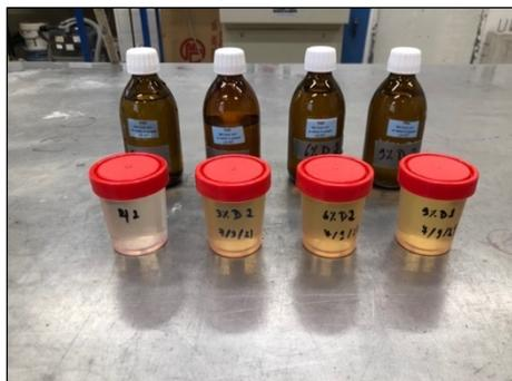
Figura 3.3 – Amostras da solução proveniente do pré-tratamento para análise química.
