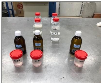
Figura 3.4 – Amostras da solução proveniente da imersão para análise química.
