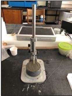
Figura 3.37 – Determinação da consistência normal.
