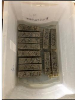
Figura 3.48 – Ensaio de secagem e molhagem nos provetes dos compósitos.
