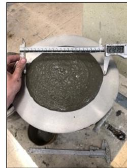
Figura 3.36 – Processo de aferição do diâmetro médio do espalhamento da pasta.
