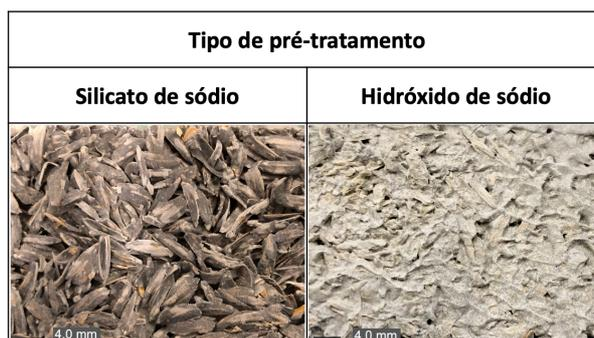
Figura 4.37 – Compósitos com 6% de pré-tratamento de NS e NH.
