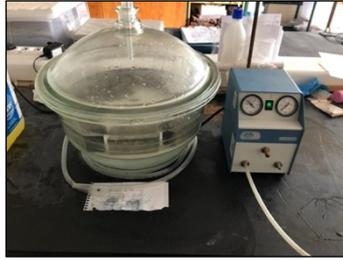
Figura 3.47 – Ensaio de porosidade aberta a decorrer nos provetes.
