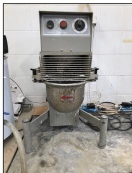
Figura 3.13 – Misturadora usada na produção de pastas cimentícias.
