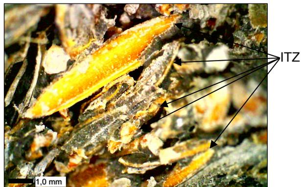
Figura 3.49 – ITZ de rutura do compósito cimentício de CA de referência aos 7 dias.
