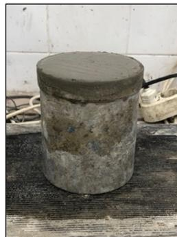
Figura 3.33 – Ensaio de massa volúmica na pasta.
