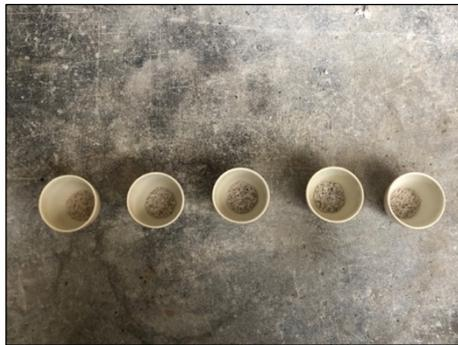
Figura 3.30 – Cadinhos com o material não volátil de cada concentração.
