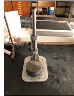
Figura 3.39 – Determinação do fim de tempo de presa.
