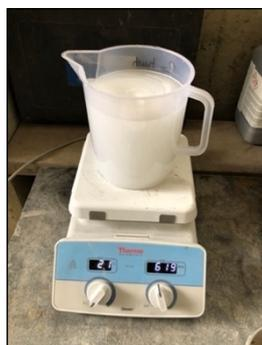
Figura 3.1 – Diluição do silicato de sódio com recurso a um agitador magnético.
