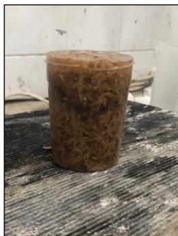
Figura 3.23 – Copo cheio com CA saturada e água, para o índice de vazios.
