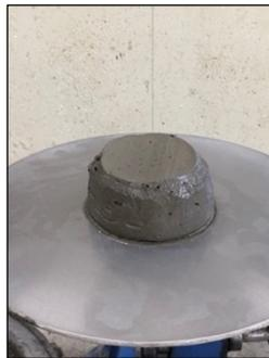
Figura 3.35 – Aspeto após retirar o molde troncocónico pasta cimentícia.
